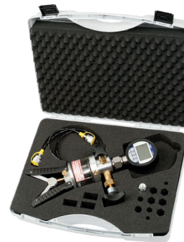
Versão básica inclusive geração de pressão hidráulica
