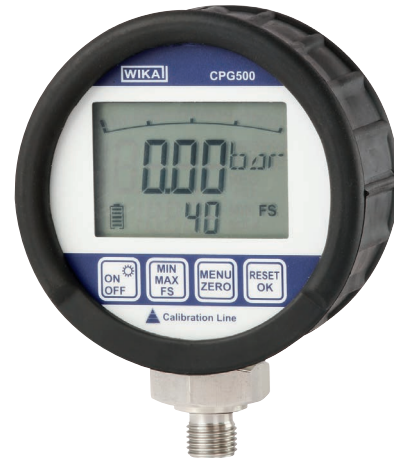
Manômetro digital de precisão, modelo CPG500
