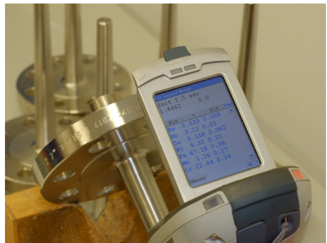
Test PMI: analisi a raggi X fluorescenti del bulbo del pozzetto termometrico
