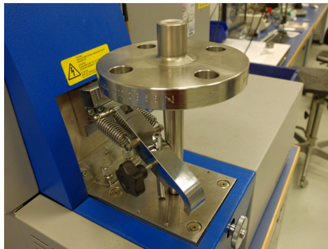
Test PMI: analisi spettrografica su un modello di pozzetto termometrico flangiato TW10
