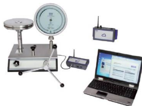
Urządzenia CPU6000-W, CPU6000-S, CPB5800 i komputer z zainstalowanym oprogramowaniem WIKA-CAL
