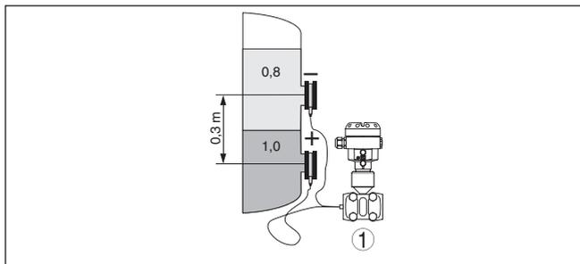
Fig. 27: Disposição na medição de camada separadora
