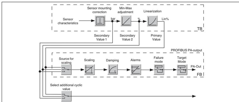
Fig. 50: DPT10: Diagrama em bloco com valor AI (PA-OUT) e Additional Cyclic Value
