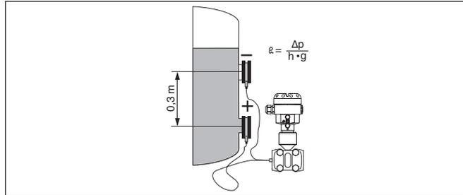
Fig. 26: Disposição para a medição de densidade
