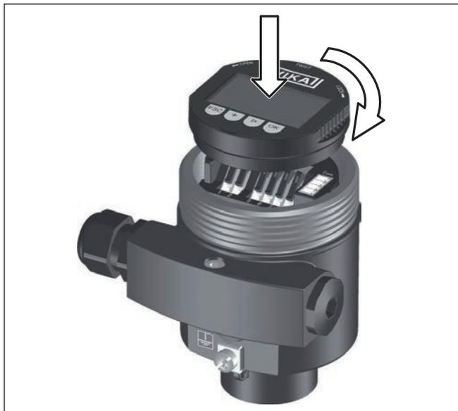
Fig. 42: Colocar o módulo de visualização e configuração
