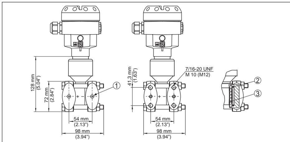
Fig. 63: Esquerda: conexão do processo DPT10 preparada para a montagem do diafragma isolador. Direita: posição do anel de vedação em cobre
