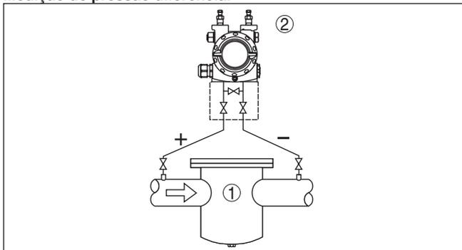
Fig. 5: Medição de pressão diferencial com DPT10
