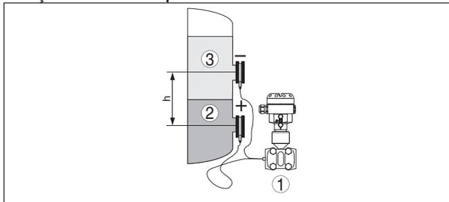
Fig. 7: Medição de camada separadora com o DPT10
