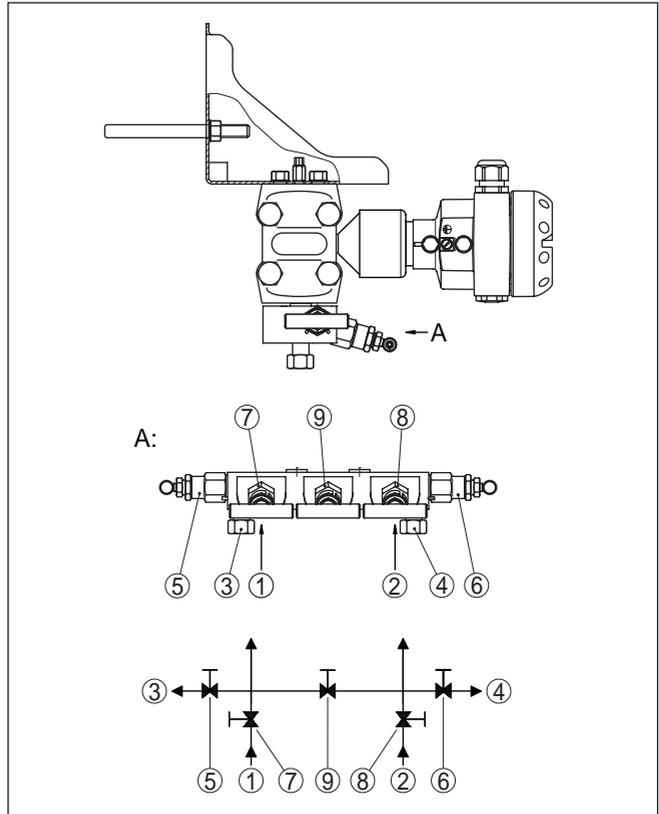
Fig. 14: Conexão de um bloco de 5 válvulas
