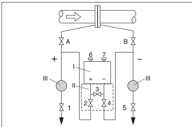
Fig. 45: Disposição preferencial para a medição de líquidos
