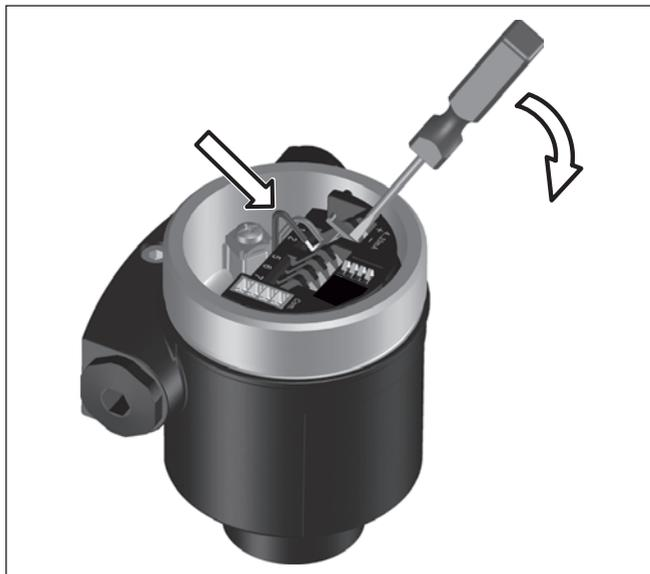
Fig. 33: Passos 6 e 7 do procedimento de conexão
