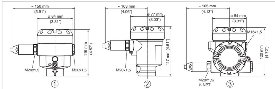
Fig. 59: Variantes da caixa com grau de proteção IP66/IP68 (1 bar) - com o módulo de visualização e configuração montado, a altura da caixa é aumentada em 9 mm/0.35 in
