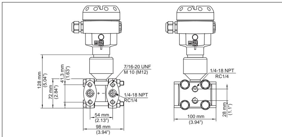
Fig. 62: DPT10, Conexão ¼-18 NPT e RC ¼, com purga de ar lateral
