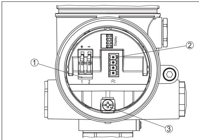
Fig. 36: Compartimento de conexão - Caixa de duas câmaras
