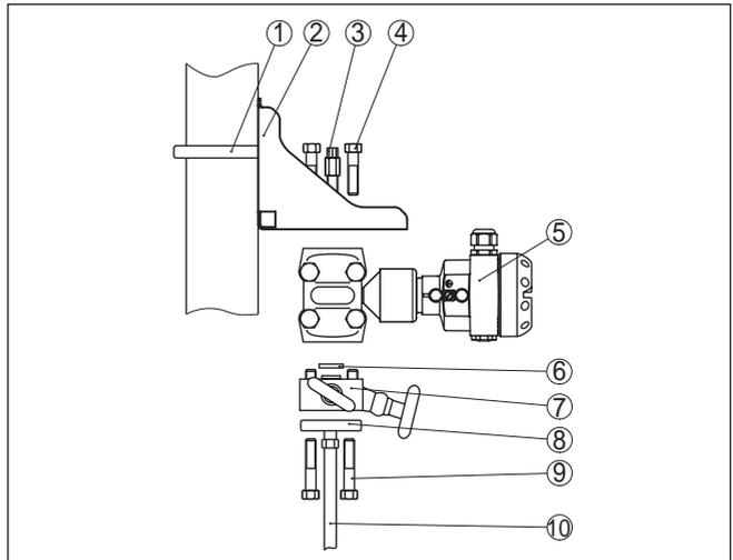
Fig. 11: Disposição de montagem na montagem em tubo
