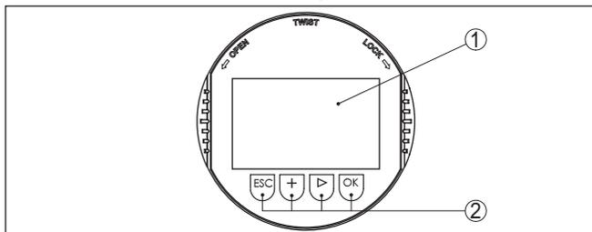
Fig. 43: Elementos de visualização e configuração
