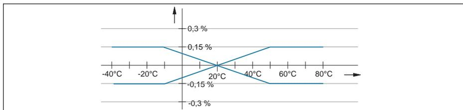
Fig. 49: Alteração térmica da saída de corrente
