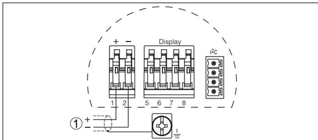
Fig. 34: Esquema de ligações - Caixa de uma câmara
