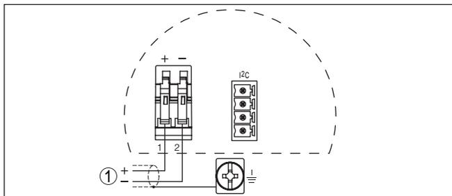
Fig. 37: Esquema de ligações - Caixa de duas câmaras
