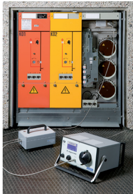
Configuración de medición con la unidad de control de presión inicial modelo GA05 y analizador GA40
