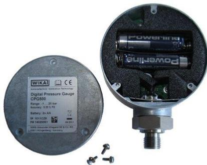
Abrir el compartimento de pilas. Colocar las pilas nuevas según la ilustración. Prestar atención a la polaridad. Pilas: 2 x 1,5 V (LR6 - AA)
