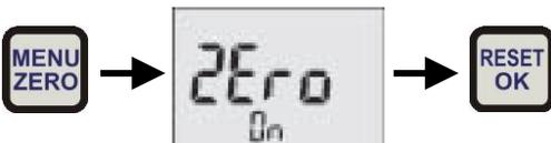
El ajuste del punto cero se ha realizado. En la pantalla se indica 0.0 bar como valor real. El ajuste permanece activo hasta que se apague el instrumento.
